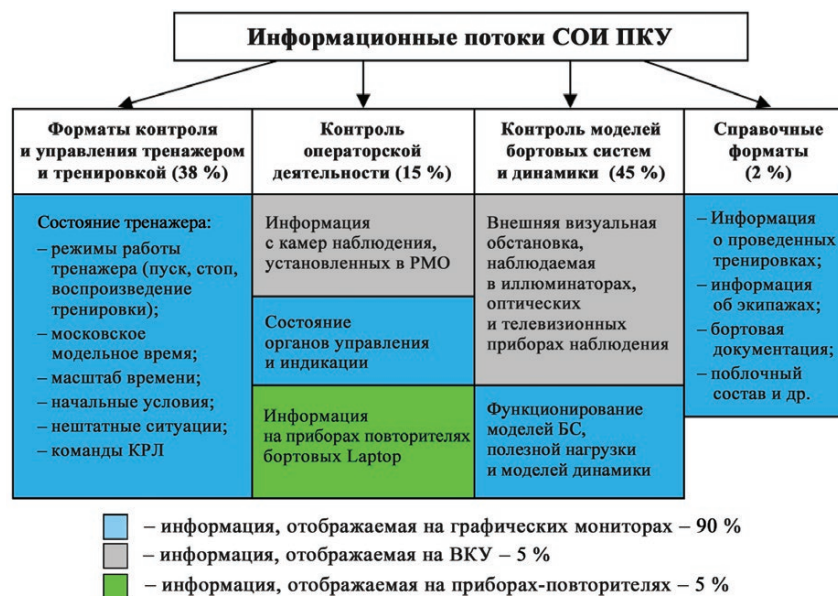
Рис. 3. Структура формализованных информационных потоков СОИ ПКУ
