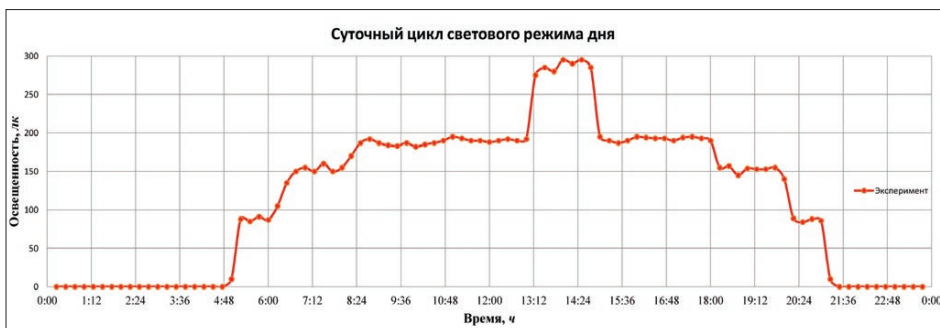
Рис. 11. Полученный суточный цикл светового режима в модуле МИМ1
