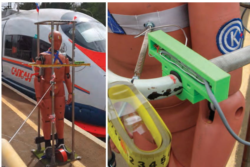
Рис. 9. Специальный комплекс контроля (СКК-4) для определения воздействия воздушного потока от движения скоростного подвижного состава на манекен, оснащенного датчиками: все устройства-приспособления СКК-4 распечатаны на 3D-принтере
