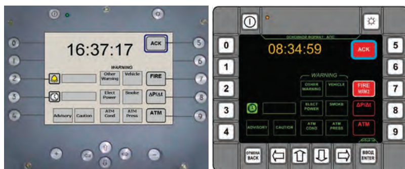
Рис. 2. Лицевые панели многофункционального пульта-индикатора предыдущей (а) и новой (б) версии
