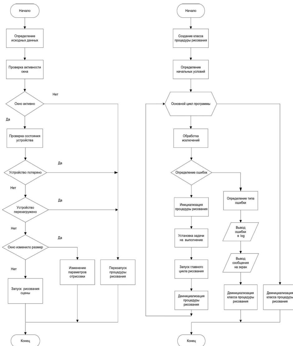
Рис. 8. Блок-схемы алгоритмов рисования трехмерной модели кнопки МПИ
