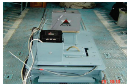
е) размещение излучателя сканера и фотокамеры над люком вертолета Ми-8
