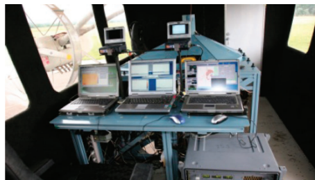
ж) многофункциональный аэросъемочный комплекс в гондole дирижабля AU-30
