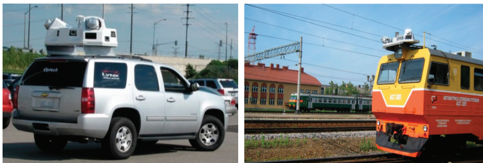
а) мобильный сканер компании OPTECH на шасси легкового автомобиля б) автомотриса, оборудованная МЛС Lynx Mobile Mapper (Октябрьская ЖД)
