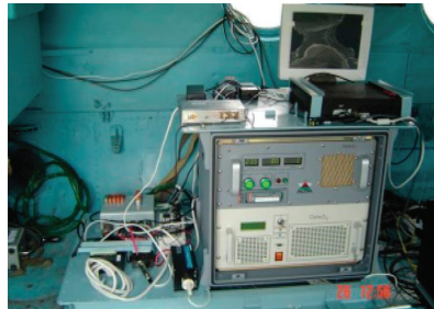
а) один из массовых воздушных лазерных сканеров ALTM-30/70 на борту Ми-8
