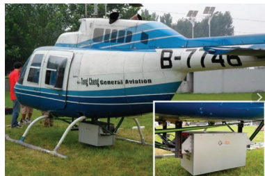
в) монтаж излучателя сканера на внешней подвеске вертолета
