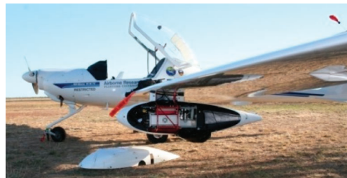
г) размещение сканера в специальном подкрыльевом пилоне легкого самолета
