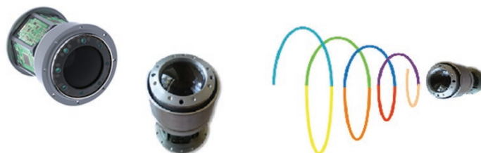
Рис. 1. Отечественные экспериментальные лазерные сканирующие системы с вертикальной (круговой или спиралевидной) разверткой луча
