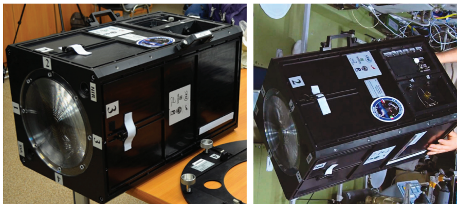
Рис. 1. Широкоугольный телескоп КЭ «УФ атмосфера» в процессе наземной подготовки (слева) и на борту МКС (справа)
