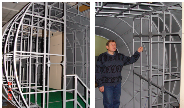
Рис. 4. Сборка УТМ КТ МЛМ для работы с манипулятором «Дон-ERA»
