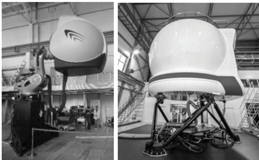
Рис. 1. Альтернативные варианты систем подвижности для имитации акселерационных воздействий: система подвижности на базе промышленного робота (слева) и система подвижности на базе платформы Стюарта
